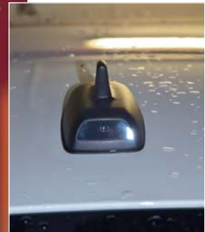
Das Bild stammt von einer Kamera im Heck, die in einer Sharkfin-Antenne versteckt ist.
