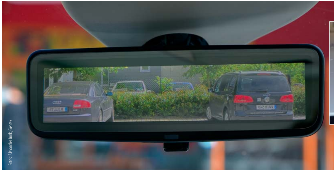
Das Bild stammt von einer Kamera im Heck, die in einer Sharkfin-Antenne versteckt ist.
