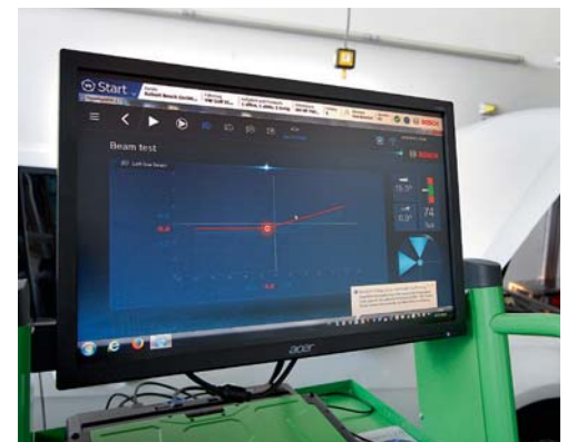
Auch das Scheinwerfereinstellgerät ist dank der Software Connected Repair vernetzt (oben). Augmented Reality: Auf dem Tablet wird die Lage des Airbagsystems angezeigt (links).
