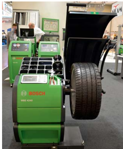
Die WBE 4240 Sonar Digital zeigt die Radbreite auf der digitalen Anzeige an.
