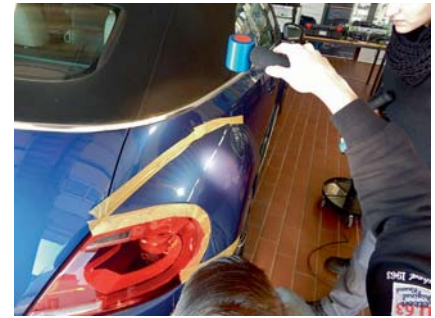
Speziallampe statt Sonne: Künstliches Tageslicht spürt letzte Schleifspuren auf.
