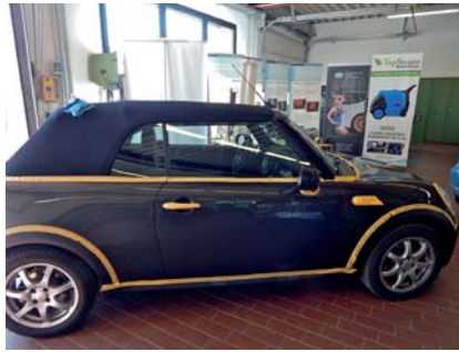
Gut vorbereitet: Exaktes Abkleben vermeidet Nacharbeiten und Schleifschäden.
