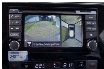
Rechts im Display kann sich der Fahrer anhand der Vogelperspektive orientieren.
