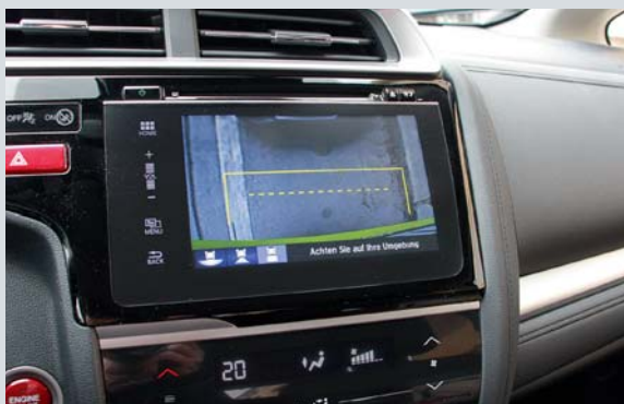
So sieht das Bild im Display aus, wenn sich der Fahrer für den „Top Down View“-Modus entscheidet.
