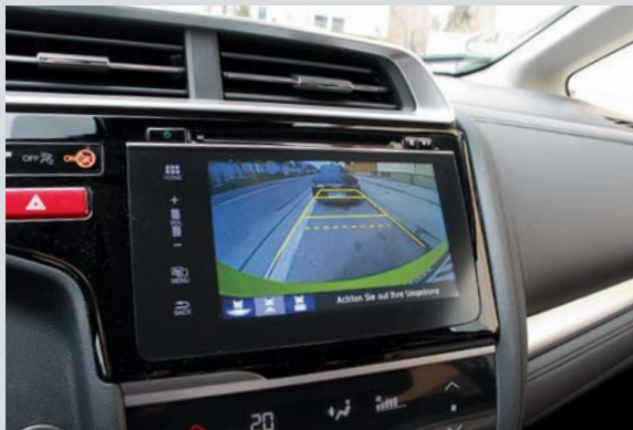
Drei verschiedene Kamerawinkel stehen im neuen Honda Jazz zur Wahl. Hier zu sehen: „Normal View“ samt Führungslinien.
