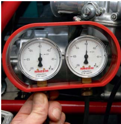
Synchronuhren, zum Einstellen der Vergaser, gibt es als analoge und digitale Geräte.
