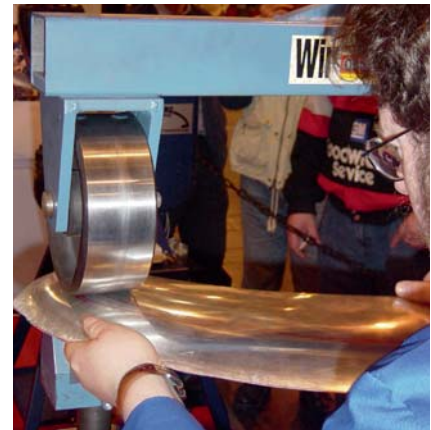
Tiefgehende Kenntnisse in der Blechbearbeitung sind wesentlich bei der Restaurierung.
