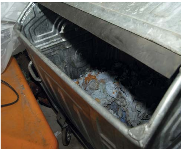
Mit Öl getränkte Reinigungstücher muss man in feuerfesten Tonnen beziehungsweise Containern mit verschließbarem Deckel entsorgen.
