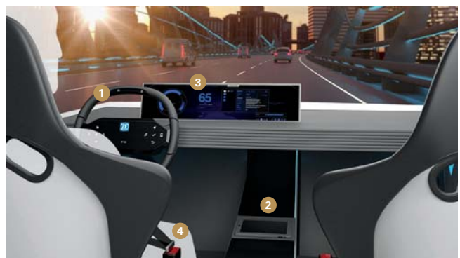
Die vier Ansätze des Concept Cockpits von ZF: spezielles Lenkrad, Touch-Display, Gesichts- und Emotionserkennung sowie aktiv agierende Gurte.
