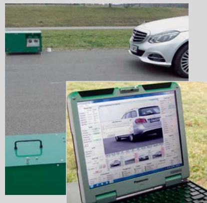
Mit RSD (Remote Sensing Device), hier von Opus Inspection, lässt sich der Schadstoffausstoß einzelner Fahrzeuge im fließenden Verkehr messen. Einem Einsatz in Deutschland steht noch der Datenschutz im Weg.
