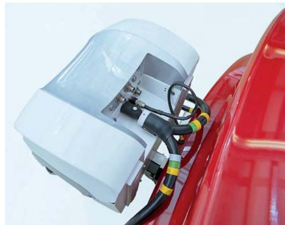
Das PEMS von AVL wird auf der Anhängerkupplung montiert und lässt sich in wenigen Minuten an einem anderen Fahrzeug anbringen.
