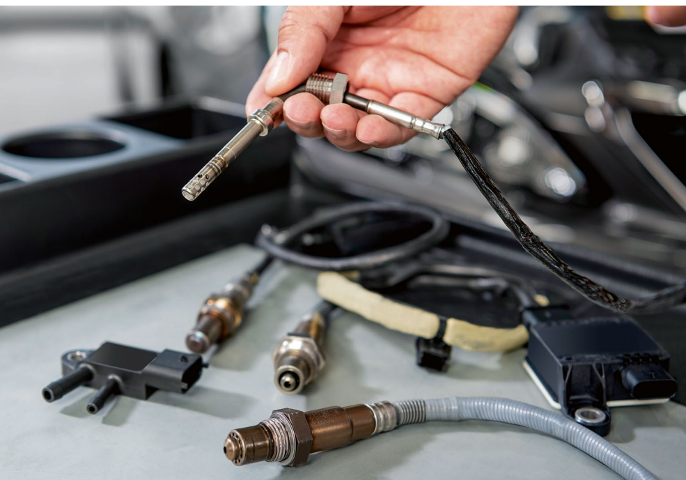
Sensoren im Abgasstrang helfen, die korrekten Emissionswerte einzuhalten.
