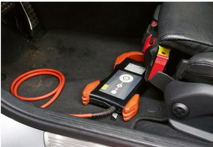
Der HU-Adapter dient während der Messung als Schnittstelle zur Motorsteuerung.
