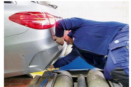
Die Messsonde wird vor der Messung am Endrohr eingeführt.
