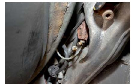
Die Luft-Verbindungsschläuche vom Kompressor zur Luftfeder sollten getrennt werden.
