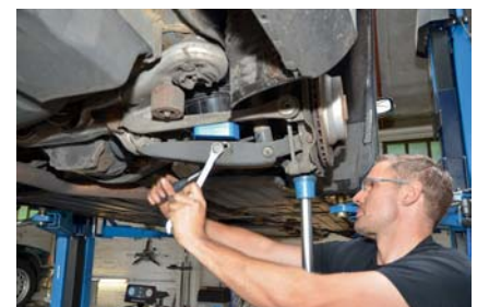
Eine Montagehilfe (Mitte) und ein Getriebeheber sind beim Einbau der neuen Feder Pflicht.
