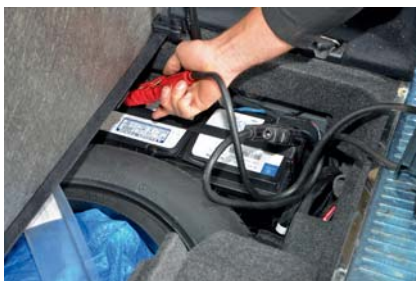
Vor der Montage sollte die Batterie an ein Erhaltungsgerät angeschlossen werden.
