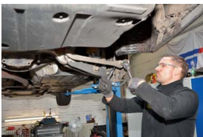
Anschließend Strebe zur Radaufhängung und Befestigung der Feder am Querlenker lösen.
