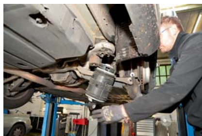
Sind die Verbindungen getrennt, lässt sich die Luftfeder aus dem Halteclip heraushebeln.
