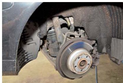
Nach der Demontage des Rades ist der Luftfederbalg hinter dem Stoßdämpfer sichtbar.
