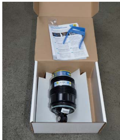
Bilstein liefert die neue B3-Luftfeder komplett mit Anleitung und Einbauhilfe im Paket.
